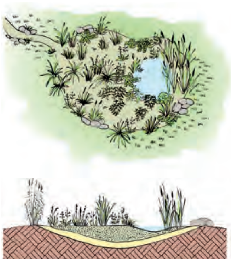
Sumpfbiotop – Funktionsschema. Die Substratschicht oberhalb der Dichtung sollte im tiefen Bereich mindestens 30 cm, besser aber 50–80 cm betragen.
