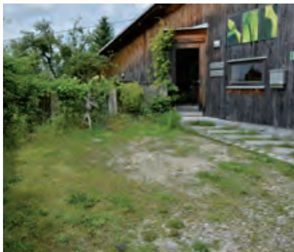
Besucherparkplatz für gelegentliche Nutzung aus Schotterrassen
